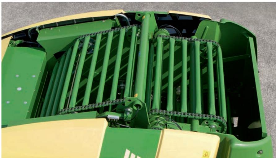
**Цепочно-трубчатый транспортер** Fortima имеет два цепочно-трубчатых транспортера. Разделение на передний и задний цепочно-трубчатый транспортер позволяет получать высокую плотность прессования и идеально сформированные рулоны.
