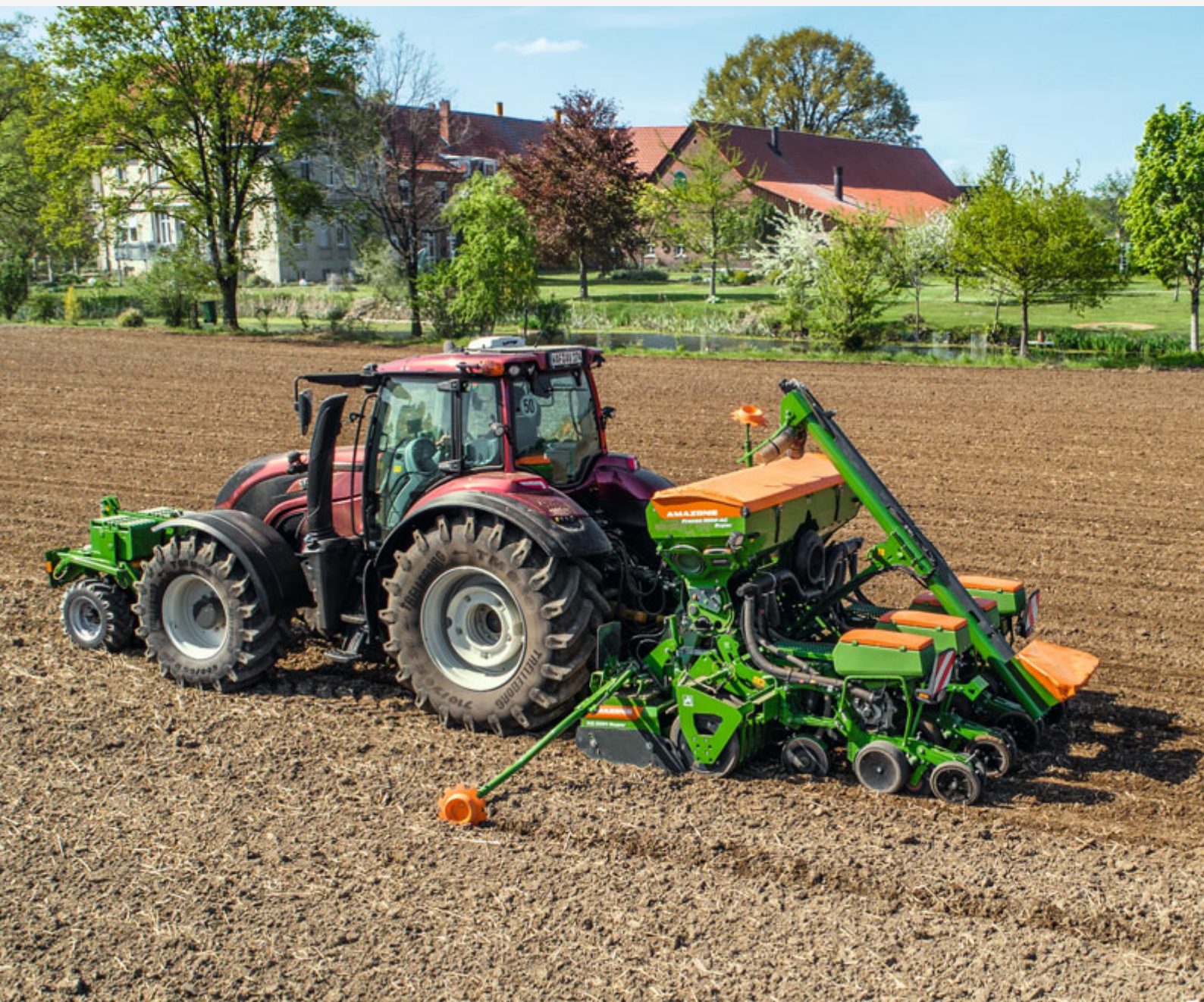
Пресеа 3000-ACC с фронтальным пакером в работе
