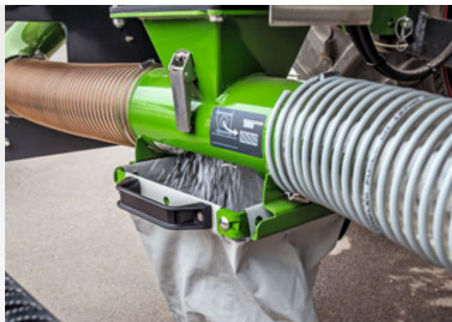
Калибровочный мешок можно комфортно повесить под дозирующим устройством
