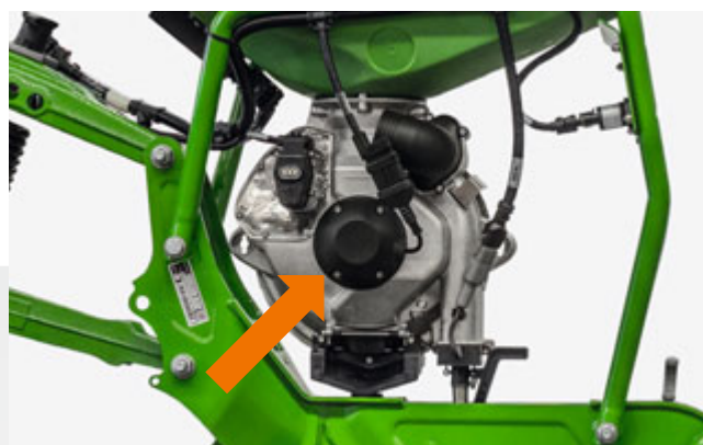
С сервоприводом дозирования посевного материала ElectricDrive
