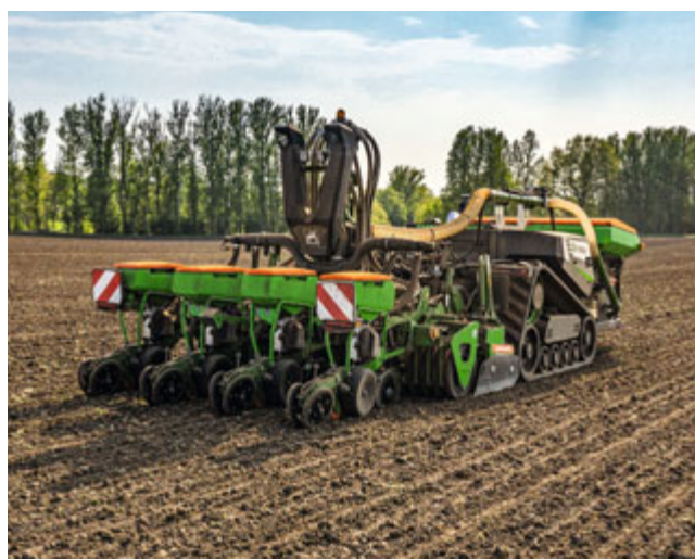
Пресеа 3000-AFCC с ротационным культиватором KG
