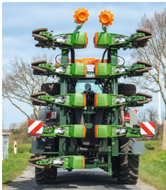
Пресеа 6000-2FCC с 9 рядами в сложенном состоянии для транспортировки по общественным дорогам
