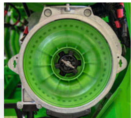
Дозирующий диск в действии (без крышки)
