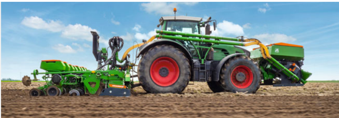
Пресеа 6000-2AFCC с ротационным культиватором KG 6002-2 и FTender 2200
