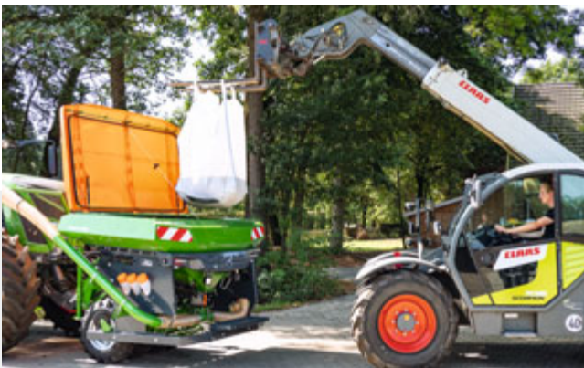
Большое отверстие бункера 1,1 м х 2,2 м для быстрого и простого заполнения FTender
