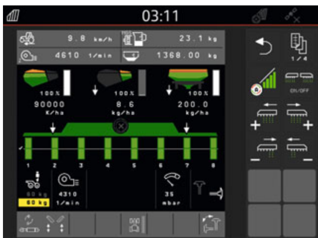
Интеграция распределителя микрогранулята в рабочее меню терминала
